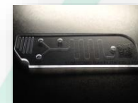
迅速診断向け 微細流路チップ
