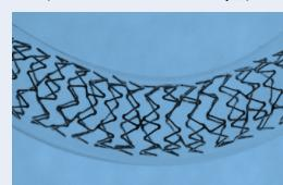
心臓の収縮・拡張に伴う、繰り返し変形による負荷を再現。数年の長期の臨床使用で起きる破断等を非臨床試験により高い確度で予測可能。
