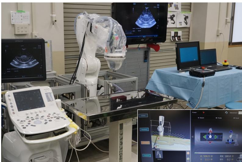
HIFU照射システム試作機
