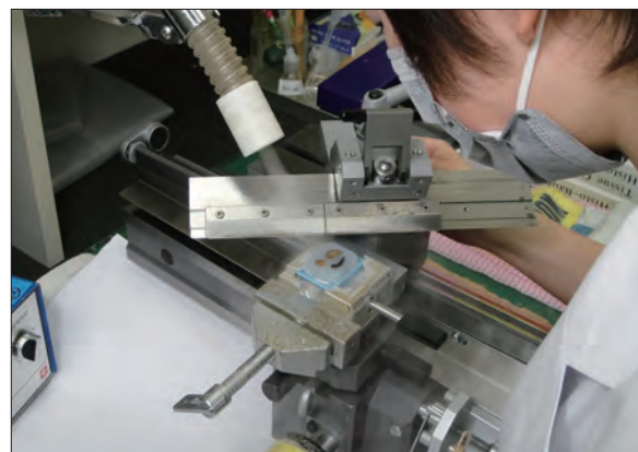
組織標本作製におけるミクロトームを用いたパラフィン切片の薄切
