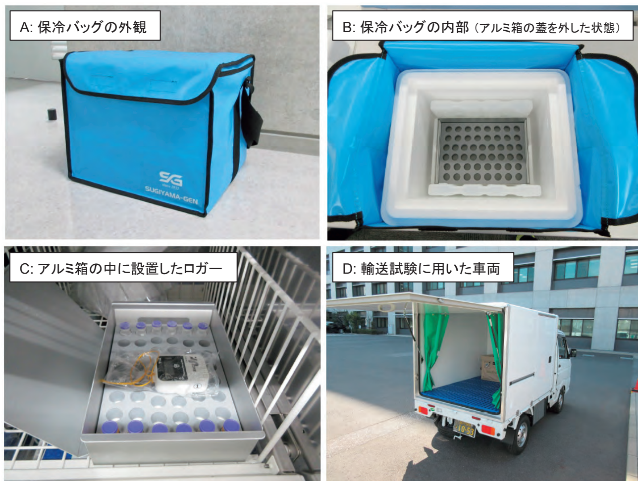
図4 コミナティの輸送に用いられた保冷バックと輸送試験に用いた車両
