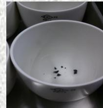
電気炉強熱後 灰化不十分
