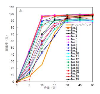
エピナスチン塩酸塩錠 20mg の公的溶出規格は、水を試験液として、毎分 50 回転で試験を行なうとき、30 分で85%以上であり、全ての製剤が規格に適合した。
